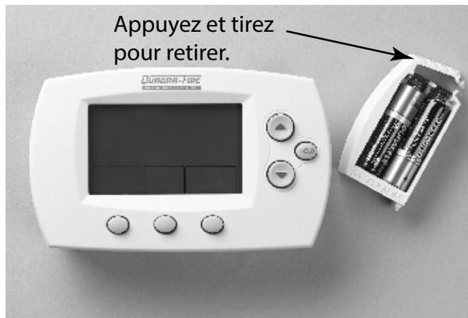
Installez immédiatement de nouvelles piles lorsque l'indicateur de **REPLACEMENT DES PILES** se met à clignoter. L'indicateur clignote deux mois avant que les piles soient totalement déchargées.
