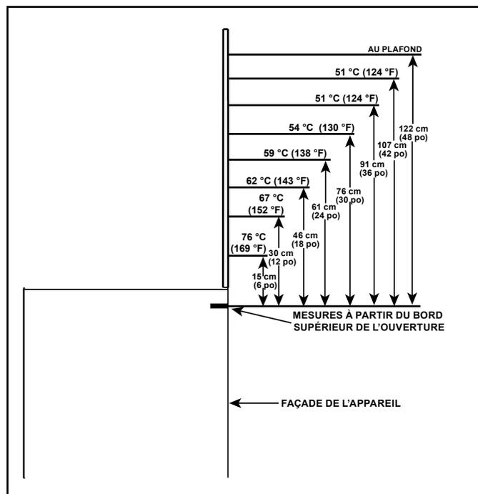
Figure 3.3. Température maximale de la surface du mur au-dessus de l'appareil
