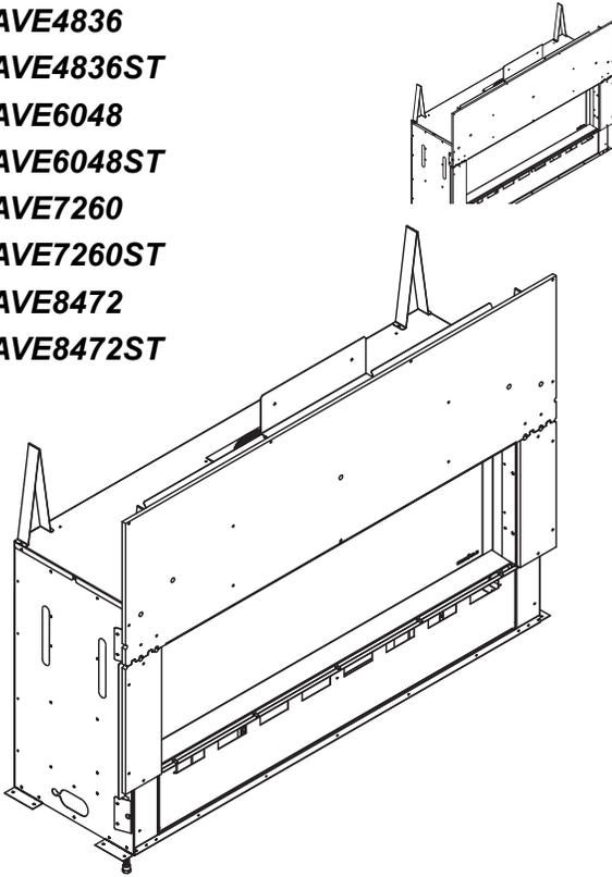
Cet appareil peut être installé en tant qu'équipement d'origine dans une maison préfabriquée (États-Unis seulement) ou maison mobile. Il doit être installé en conformité avec les instructions du fabricant et les *Manufactured Home Construction and Safety Standard, Title 24 CFR, Part 3280* aux États-Unis ou les *normes d'installation pour maisons mobiles, CAN/CSA Z240 Séries MH*, au Canada.
