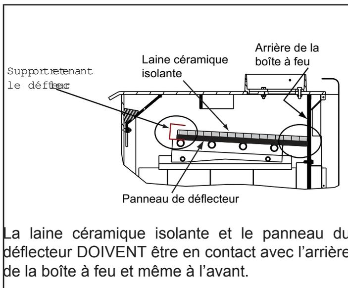
La laine céramique isolante et le panneau du déflecteur DOIVENT être en contact avec l'arrière de la boîte à feu et même à l'avant.
