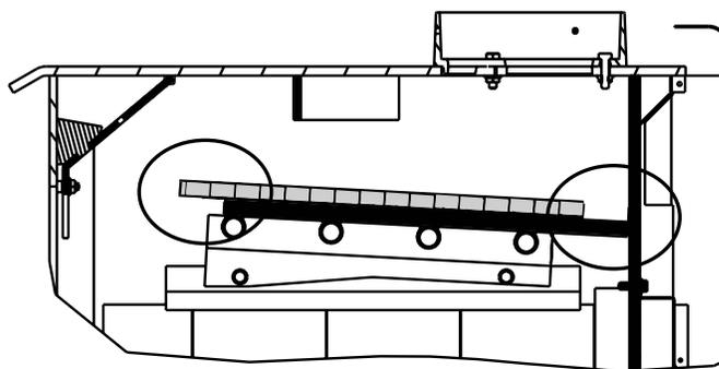
La laine céramique isolante n'est PAS en contact avec l'arrière de la boîte à feu, NI avec le déflecteur à l'avant.
