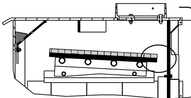
La laine céramique isolante et le panneau du déflecteur ne sont PAS en contact avec l'arrière de la boîte à feu.
