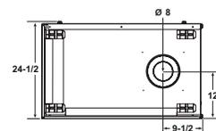
Les dimensions indiquées sont en pouces [et en millimètres]. Ces dimensions sont données à titre indicatif seulement. Nous recommandons de mesurer l'appareil au moment de l'installation. Supposez l'utilisation de cloisons sèches de 1/2 po. NOTA : Il est possible de poser un matériel non combustible de dimensions supérieures à celles indiquées. Assurez-vous de ne PAS couvrir l'ouverture de la porte décorative.
