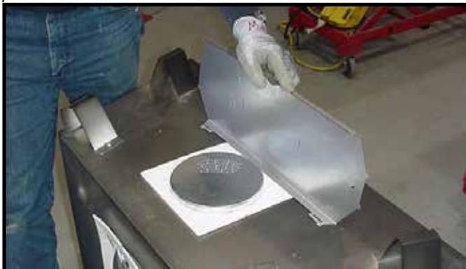
**Figure 6.2** Faites tourner l'écran thermique supérieur en position verticale, tel que montré ci-dessus. L'écran thermique doit demeurer en position verticale.
