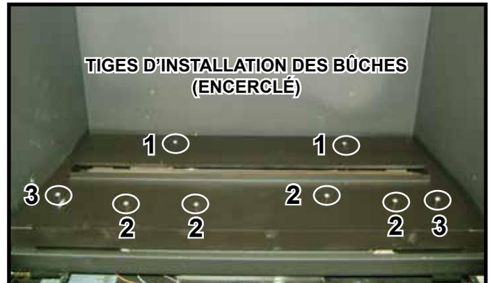
Figure 2. Emplacement des tiges d'installation des bûches et numéro des bûches correspondantes.
