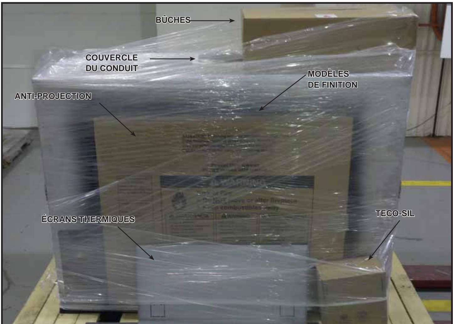
Figure 6.1. Emplacement de transport des composants
