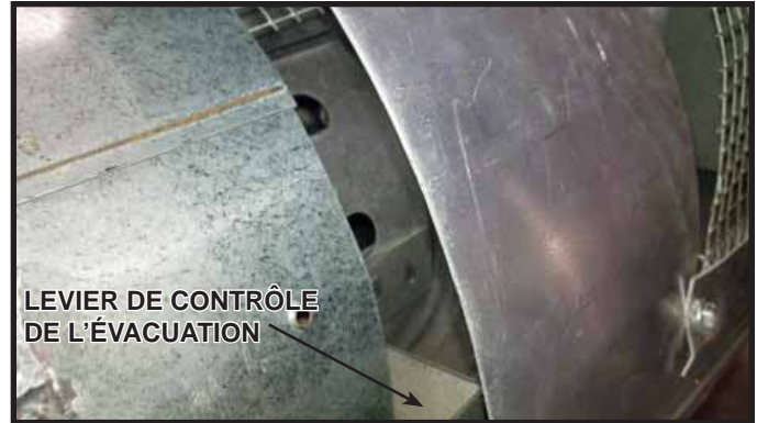
Figure 4.12 Ajustement du levier de contrôle PVK-80 – Ouvert
