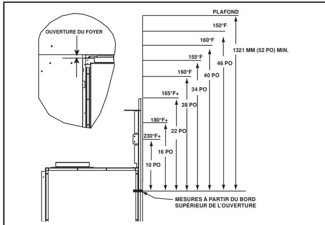
Figure 3.4 Températures de la surface du mur
