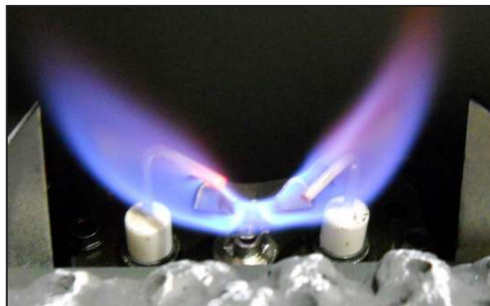
Figure 4.3 Forme de flamme de la veilleuse IPI
