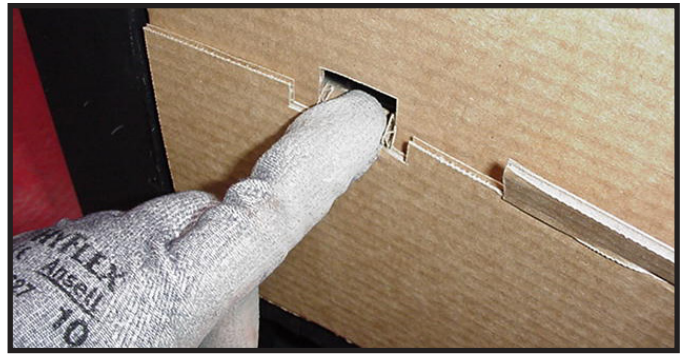
Figure 13.9 Fixation des languettes dans le devant du protecteur antiéclaboussure
