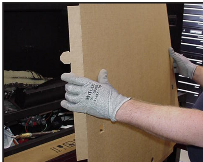
Figure 13.3 Pliage des côtés gauche et droit du protecteur antiéclaboussure
