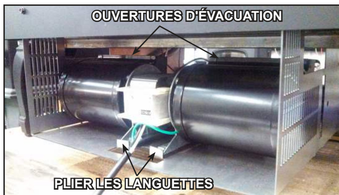
Figure 8.4 Logement du ventilateur
