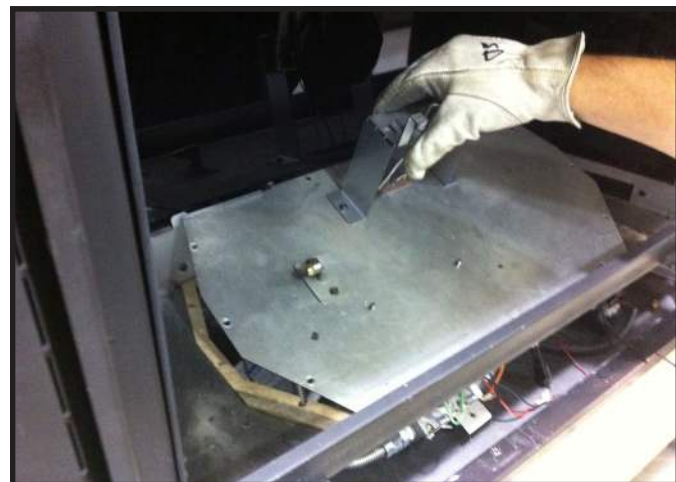
Figure 11.3. Déposez la plaque de vanne
