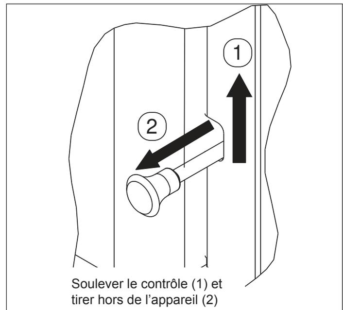
**Figure 11.2 Commande manuelle de la minuterie**
