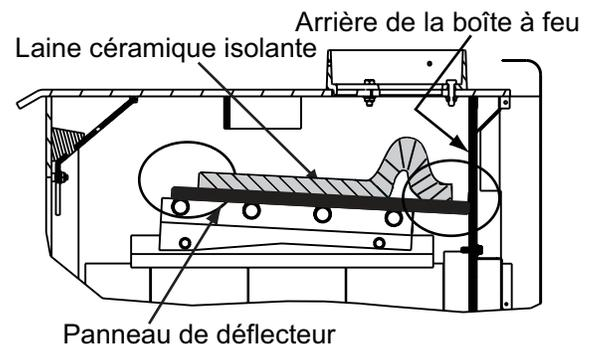
Figure 13.2 - Dispositions incorrectes du déflecteur et de laine céramique
