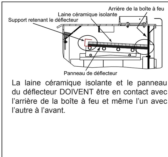
Figure 13.1 - Correctes dispositions du déflecteur et de la laine céramique
