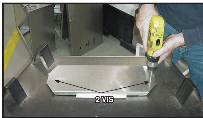
Figure 9.3 Pour l'évacuation par le dessus, enlevez les deux vis qui attachent l'écran de chaleur supérieur. Pour l'évacuation arrière, voir la section 9.B.
