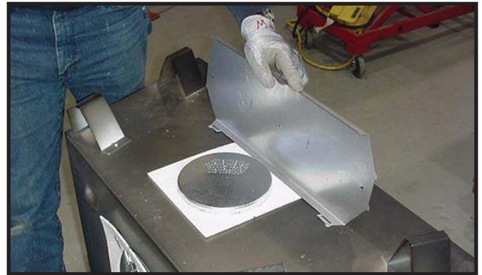
Figure 9.4 Tel qu'illustré, tourner l'écran thermique supérieur de manière à le mettre en position verticale. L'écran thermique doit demeurer en position verticale.
