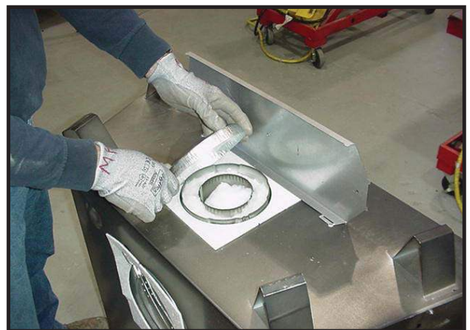
Figure 9.6 Retirer le capuchon d'évent.
