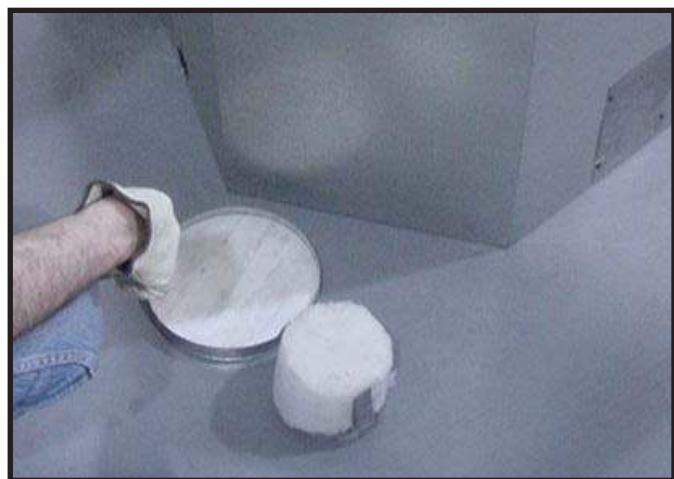
Figure 9.15 Jeter le capuchon d'évent, et retirer et jeter le panier d'isolation. Note : Une fois le capuchon d'évent retiré, il ne peut être rattaché.
