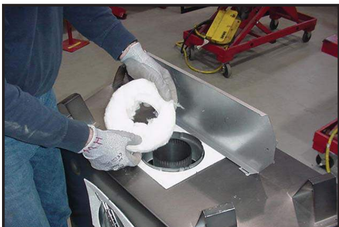
Figure 9.8 Retirer l'isolant du tuyau du conduit d'évacuation extérieur.
