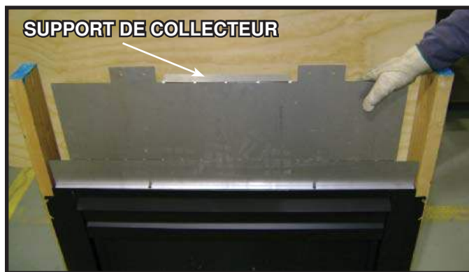
Figure 9.2 Confirmer que le support de collecteur est courbé à un angle de 90 degrés vers l'arrière de l'appareil.
