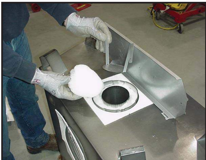
Figure 9.7 Retirer le panier isolant et l'isolant blanc du tuyau du conduit d'évacuation central.
