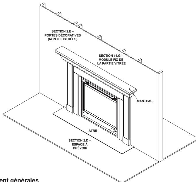
Figure 2.1 Pièces de fonctionnement générales
