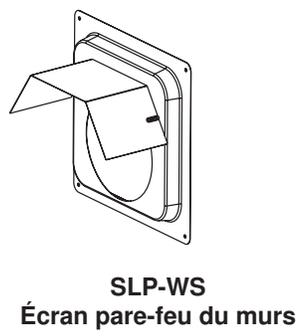
Figure 16.9 Composants du conduit d'évacuation de la série SLP
