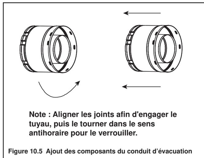
**Note :** Aligner les joints afin d'engager le tuyau, puis le tourner dans le sens antihoraire pour le verrouiller.
