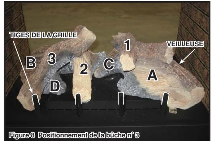
**ÉTAPE 4. Bûche n° 3 (SRV2128-707) :** L'extrémité inférieure de la bûche n° 3 doit entrer en contact avec la tige de la grille la plus à gauche. Joindre la partie inférieure de la bûche n° 3 aux indentations de la bûche D et au dessus de la bûche n° 2.
