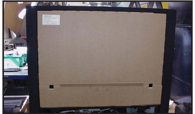
Figure 13.10 Écran anti-éclaboussures avec panneau d'accès inférieur ouvert
