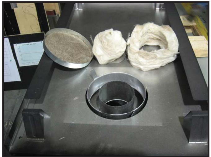
**Figure 9.4** Retirer et jeter le capuchon plombé, le beigne d'isolation, le bouchon isolant et le panier d'isolation. Brancher la première section du conduit d'évacuation (elle va s'enclencher). Glisser le joint du conduit d'évacuation sur la section du conduit, puis contre l'appareil. Fixer le joint du conduit d'évacuation sur l'appareil à l'aide des vis autotaraudeuses se trouvant dans le sac du manuel. Note : Le joint du conduit d'évacuation se trouve dans le sac du manuel.
