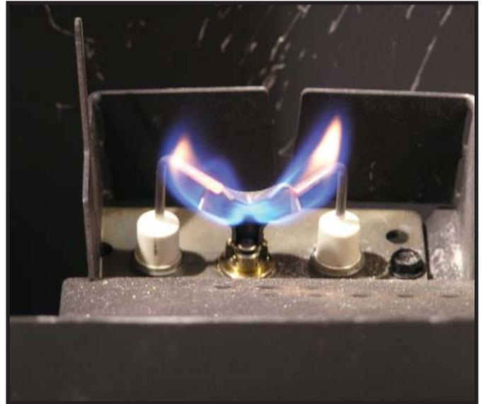
Figure 3.1 Forme de la flamme d'une veilleuse Intellifire
