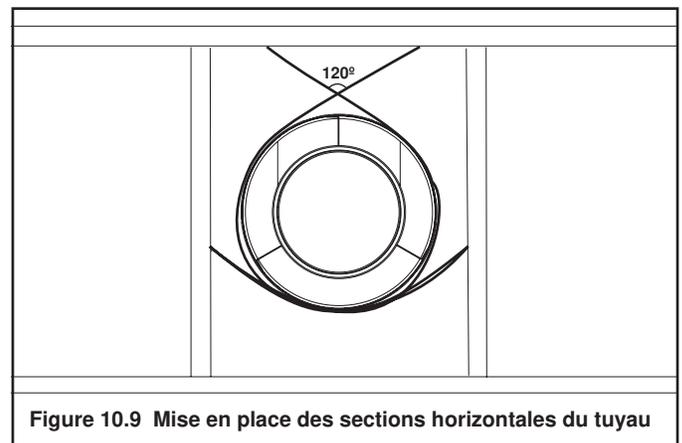
Figure 10.9 Mise en place des sections horizontales du tuyau
