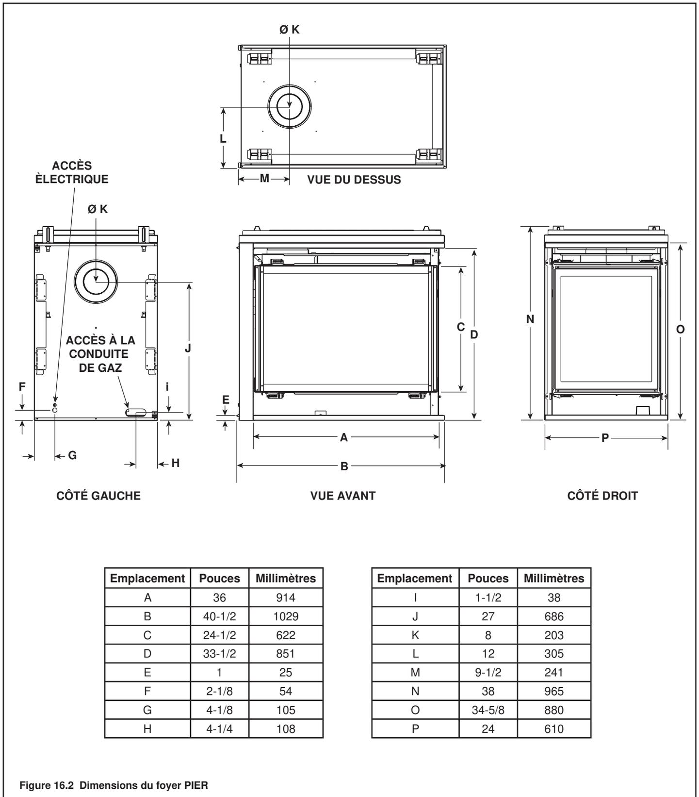
Figure 16.2 Dimensions du foyer PIER
