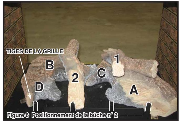
**ÉTAPE 3. Bûche n° 2 (SRV2128-705) :** L'extrémité en « Y » de la bûche n° 2 doit reposer sur la bûche B et la bûche C. L'autre extrémité doit entrer en contact avec la deuxième tige de la grille à partir de la gauche. Joindre la partie inférieure de la bûche n° 2 aux encoches se trouvant sur le dessus de la bûche B et à la surface lisse située sur le dessus de l'extrémité de la bûche C.
