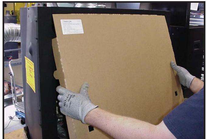
Figure 13.4 Installation de l'écran anti-éclaboussures
