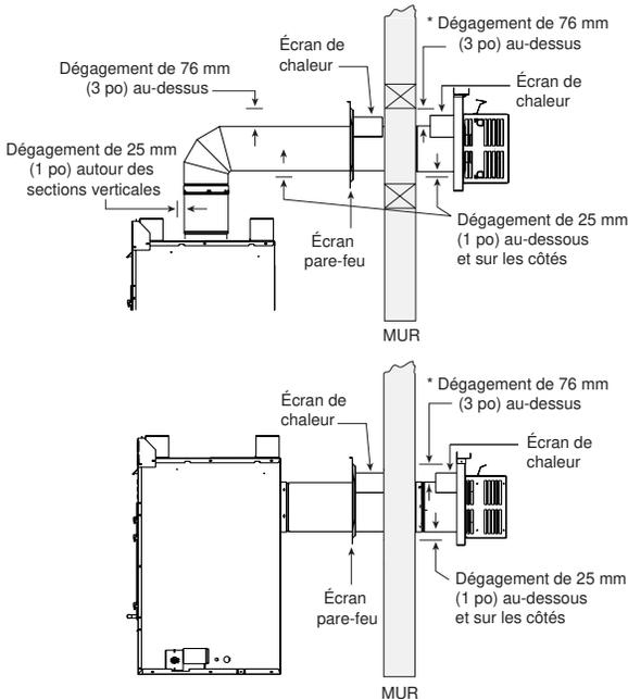
\* Au moment d'utiliser un tuyau SLP, les dégagements minimum entre le tuyau du conduit d'évacuation et les matériaux combustibles aux écrans pare-feux doivent présenter les dimensions suivantes :
