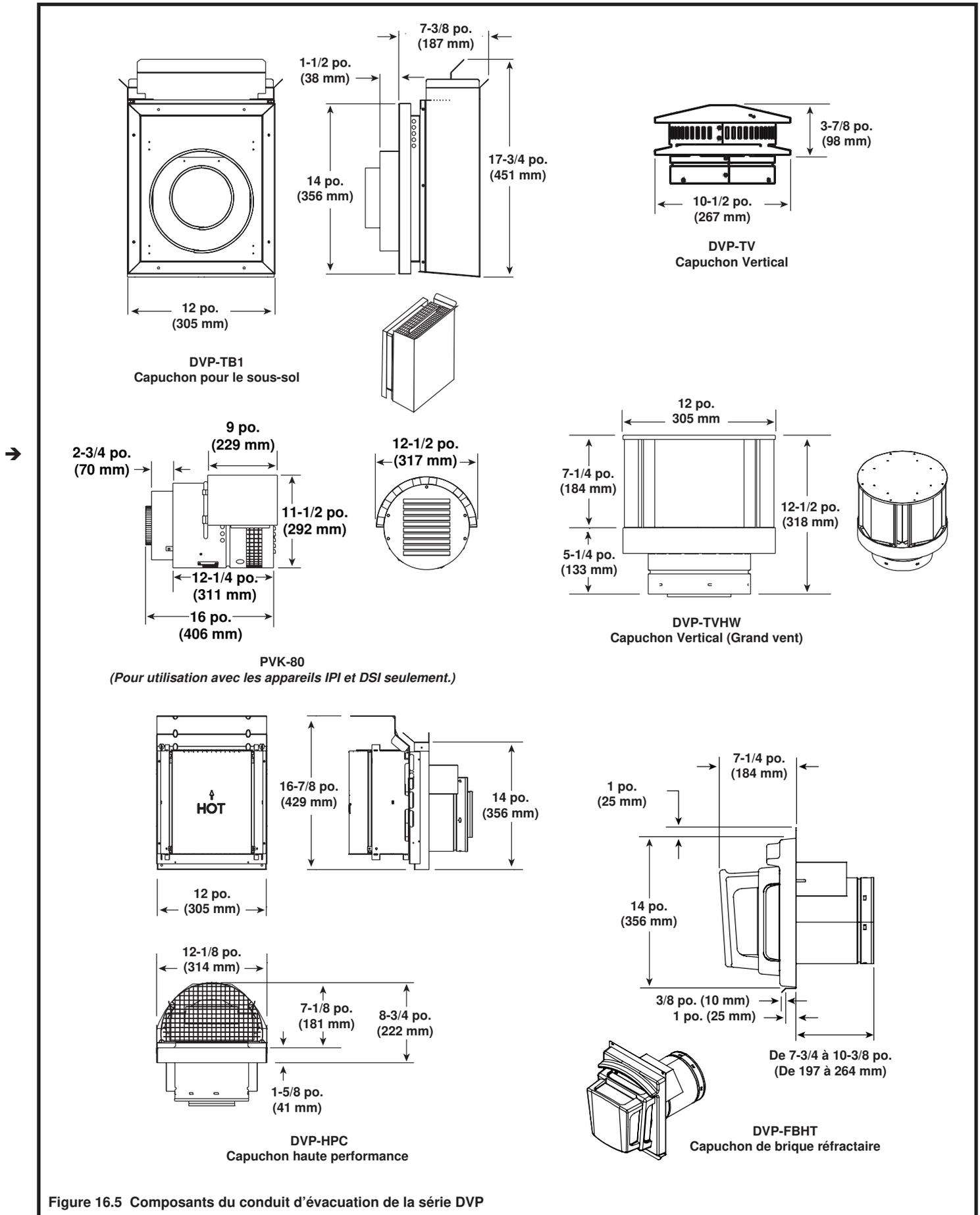
Figure 16.5 Composants du conduit d'évacuation de la série DVP
