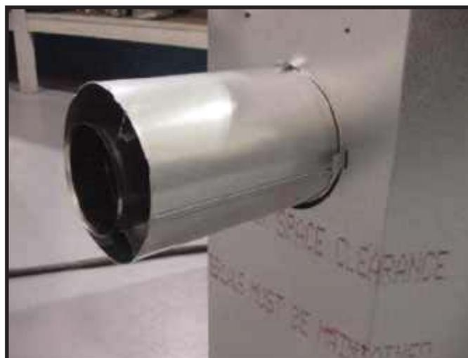
**Figure 9.8** Brancher la première section du conduit d'évacuation (elle va s'enclencher). Glisser le joint du conduit d'évacuation sur la section du conduit, puis contre l'appareil. Fixer le joint du conduit d'évacuation sur l'appareil à l'aide des vis autotaraudeuses se trouvant dans le sac du manuel. Note : Le joint du conduit d'évacuation se trouve dans le sac du manuel.
