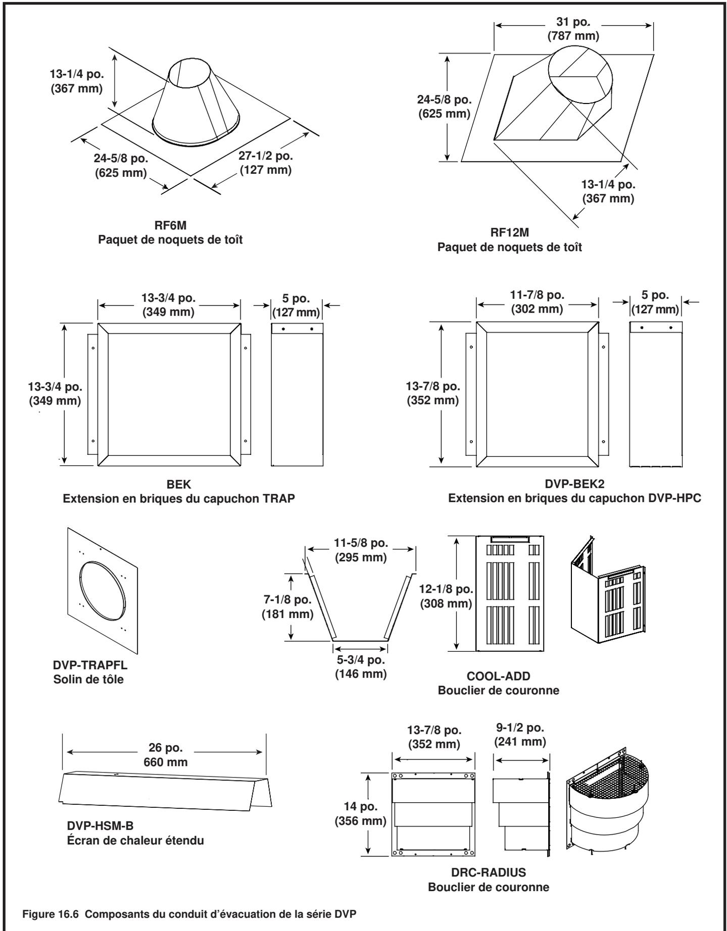
Figure 16.6 Composants du conduit d'évacuation de la série DVP
