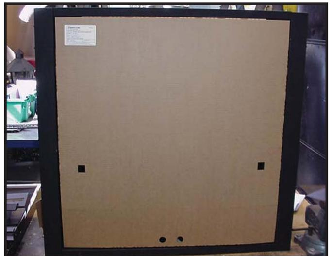
Figure 13.11 Écran anti-éclaboussures avec panneau d'accès inférieur fermé
