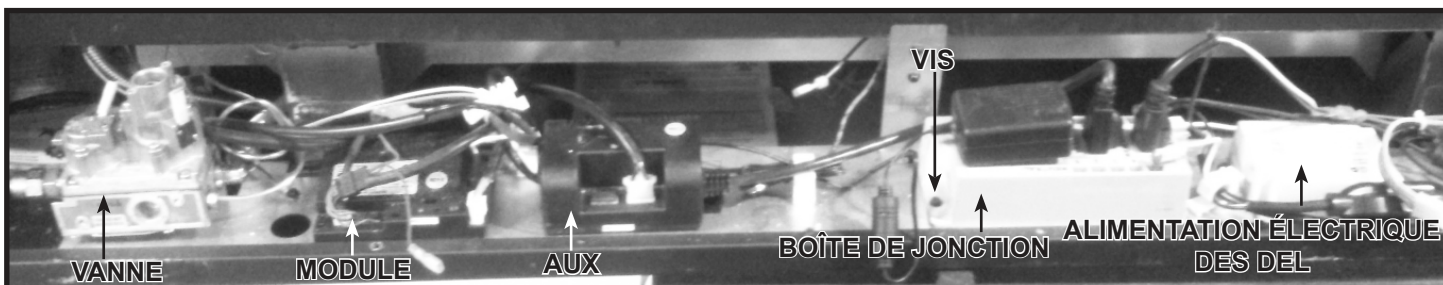
Figure 8.4. Cavité de la vanne (panneau protecteur de l'accès inférieur retiré)
