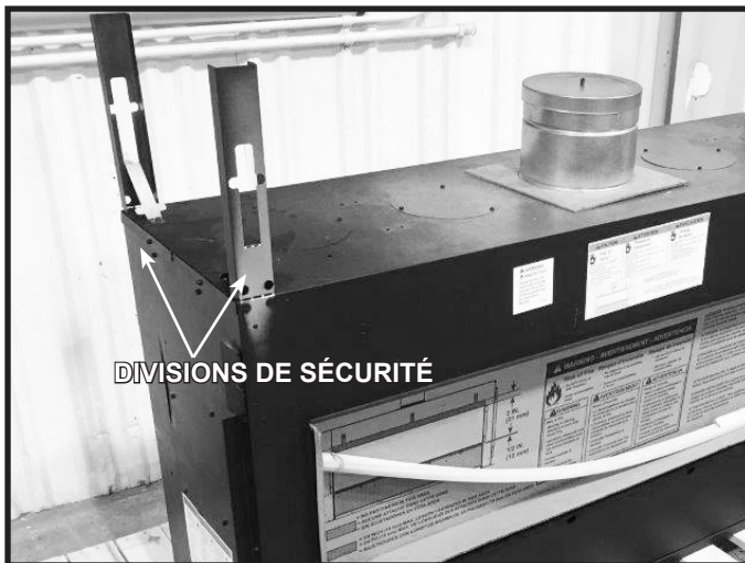
Figure 6.2 Divisions de sécurité en position verticale
