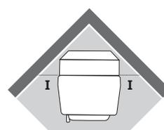
\*Si vous utilisez un tuyau d'évacuation de type PL de 3 po, il doit y avoir un dégagement de 3 po avec le combustible.
