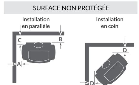
Protecteur de plancher standard : au moins 44 po x 46 po. Consultez le manuel pour voir les tailles et diagrammes de protecteur de plancher en coin pour les tuyaux à paroi simple et à double paroi ainsi que la liste complète des dégagements à respecter avant l'installation. Un adaptateur ovale à rond sera nécessaire pour l'installation.
